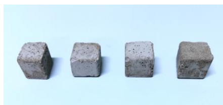
Рисунок 3-20 – Внешний вид образцов цементобетонных смесей, содержащих оксид трития
