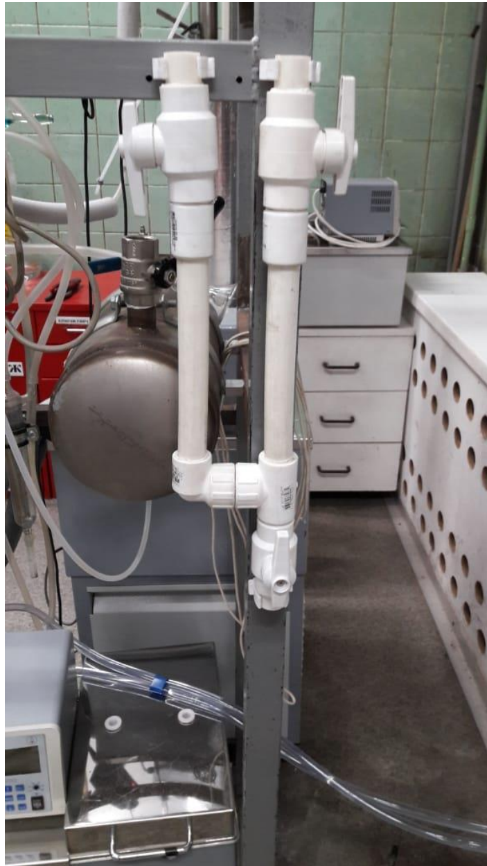
Рисунок 3-27 – Установка для определения проницаемости цементобетонных образцов по тритию
