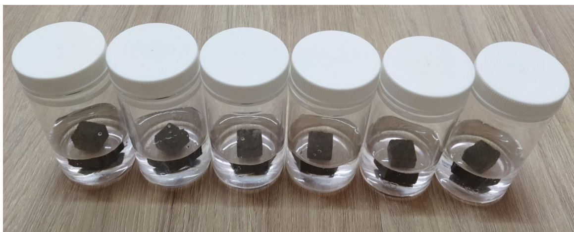
Рисунок 3-30 – Внешний вид иммобилизованных бериллиево-тритиевых отходов и процесс их выщелачивания
