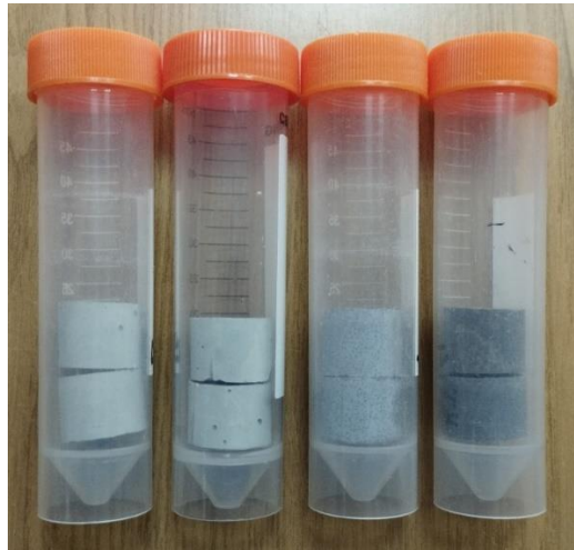
Рисунок 3-19 – Внешний вид образцов цементобетонных смесей, содержащих оксид дейтерия
