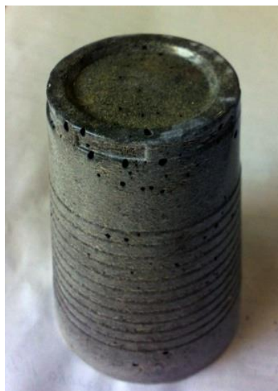
Рисунок 3-7 – Бериллийсодержащий цементобетонный образец
