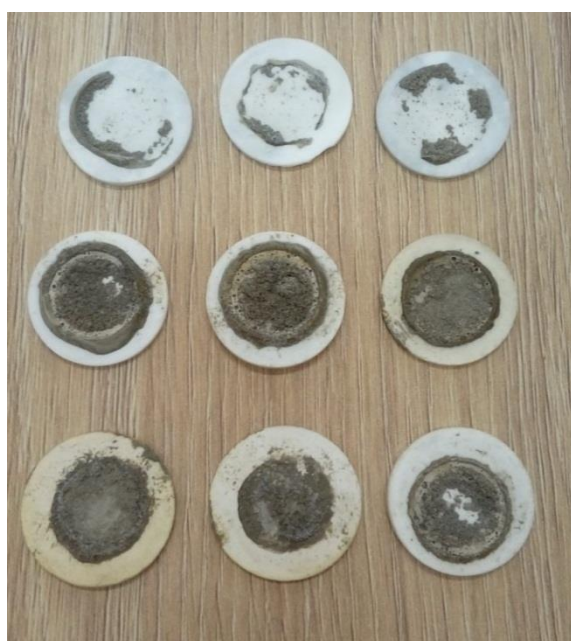
Рисунок 3-6 – Подложки после испытаний бетонных образцов на прочность сцепления
