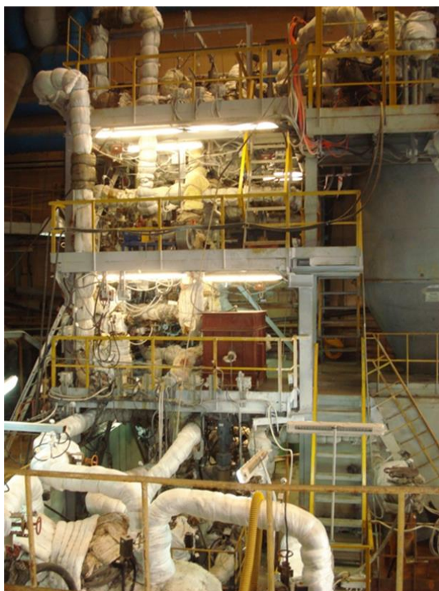
Рисунок 2.1 – Внешний вид опытной установки для изучения процессов абсорбции и десорбции паров ZrCl_4 расплавом KCl-AlCl_3
