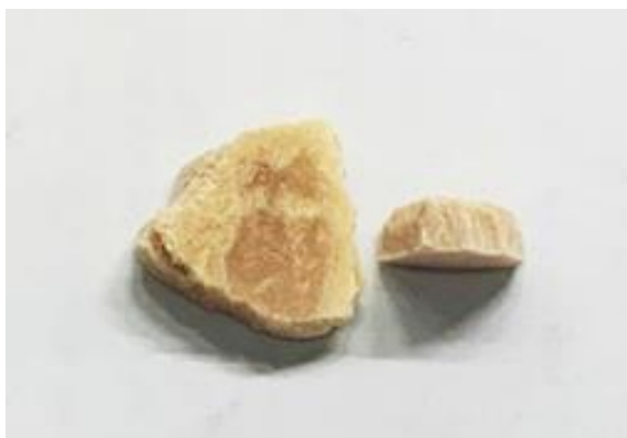
Рисунок 2.7 – Внешний вид пробы расплава KCl-AlCl_3-ZrCl_4-HfCl_4 после кристаллизации
