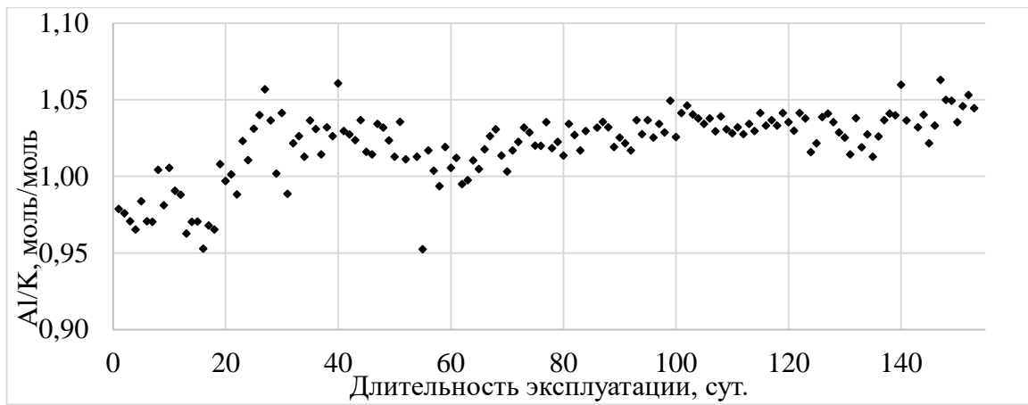
Рисунок 4.1 – Изменение мольного соотношения Al/K в расплаве \text{KCl}-\text{AlCl}_3-\text{ZrCl}_4-\text{HfCl}_4 в процессе эксплуатации установки экстрактивной ректификации \text{ZrCl}_4 и \text{HfCl}_4 АО ЧМЗ
