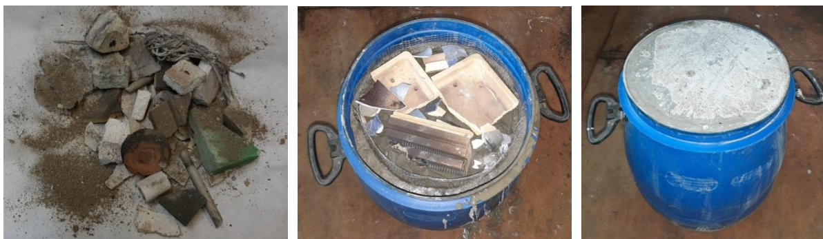
а – бериллийсодержащие отходы, б – процесс иммобилизации бериллийсодержащих отходов, в – иммобилизованные отходы Рисунок 9 – Процесс иммобилизации бериллийсодержащих отходов
