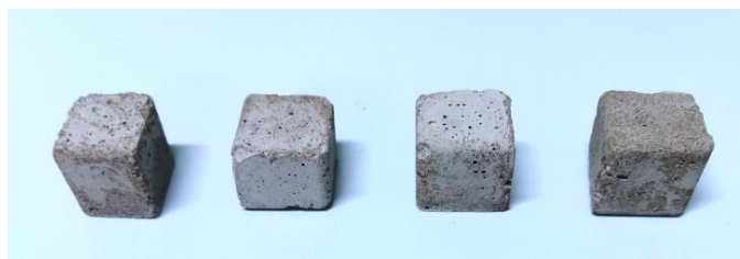
Рисунок 6 – Внешний вид цементобетонных образцов с иммобилизованным тритием
